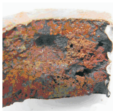
Fot. 1. Widok wewnętrznej powierzchni wycinka, z wżerami korozyjnymi
