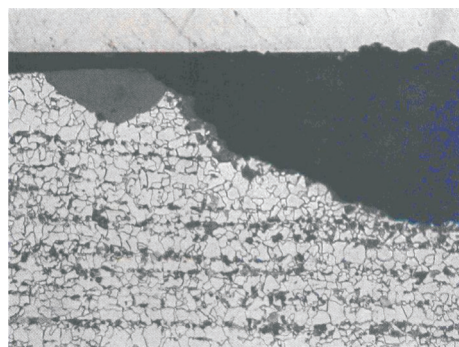
Fot. 5. Mikrostruktura podłoża stalowego i zgorzeliny (powiększenie 250:1)
