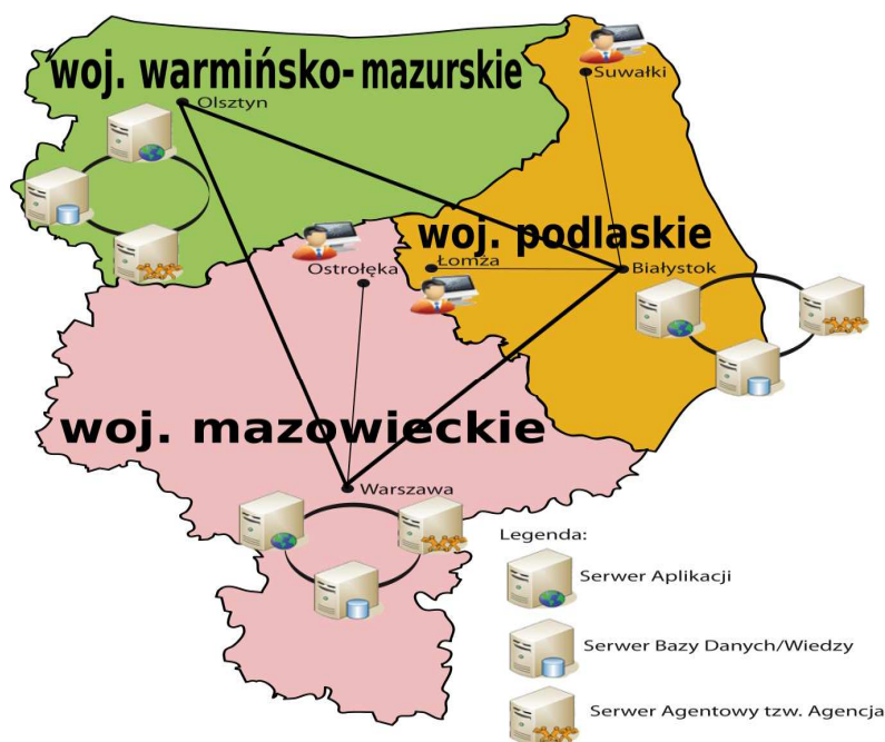
Ryc. 4 Przykładowa realizacja architektury agentowej dla warstwy programowej składającej się z trzech węzłów głównych
