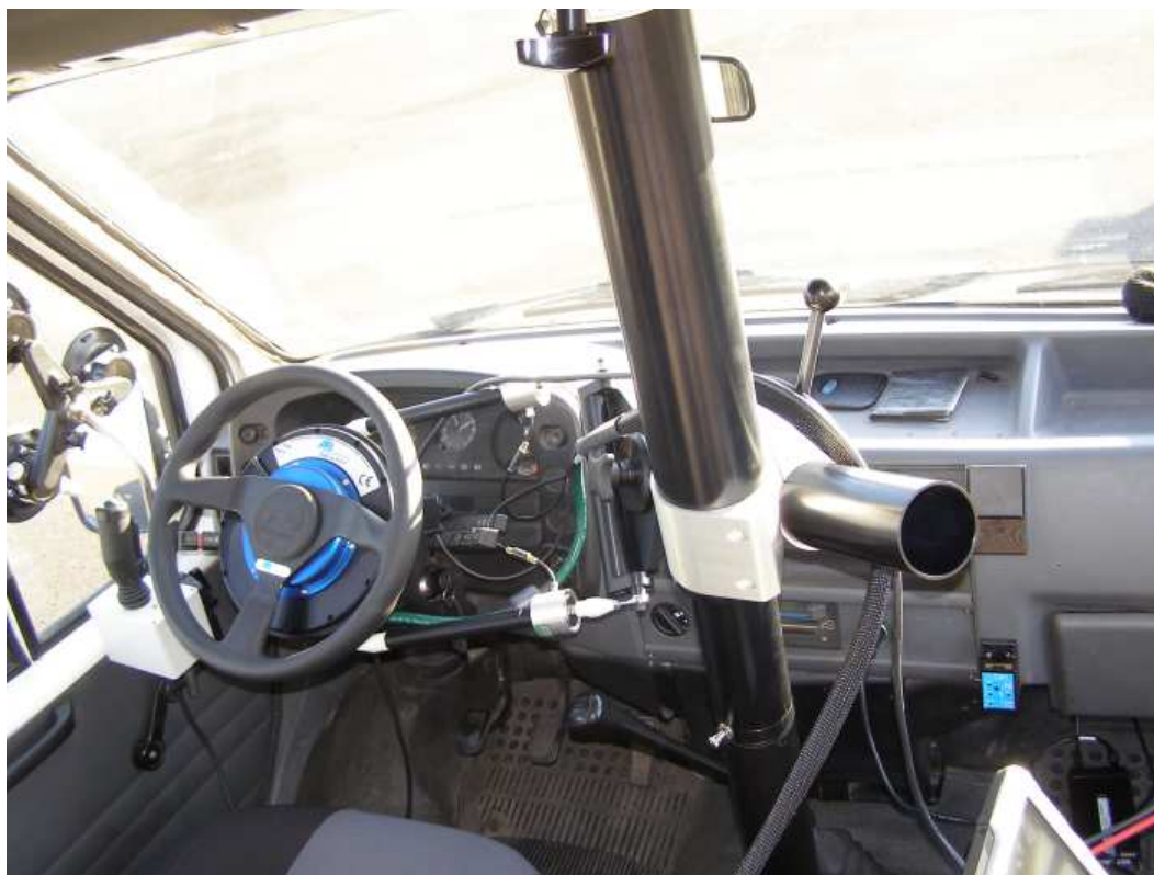
Fot.2. Robot sterujący. a. system inercyjno satelitarny RT 3002, b. jednostka centralna, c. kierownica pomiarowa z kolumną ustalającą
