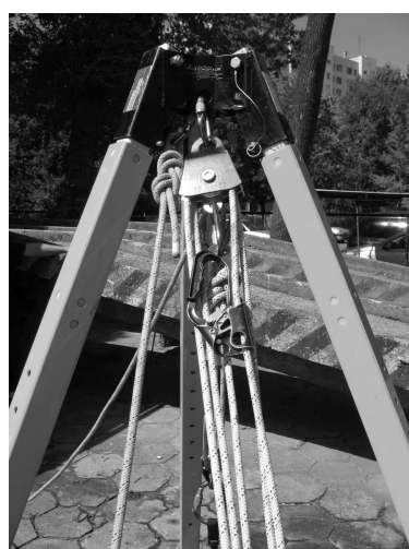
Ryc. 18. Bloker wykonany za pomocą Poigne
