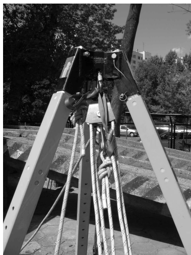
Ryc. 17. Bloker wykonany za pomocą węzła francuskiego
