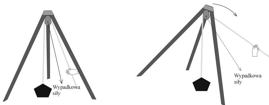
Ryc. 16. Prawidłowe i błędne wybieranie kierunku działania siły.
