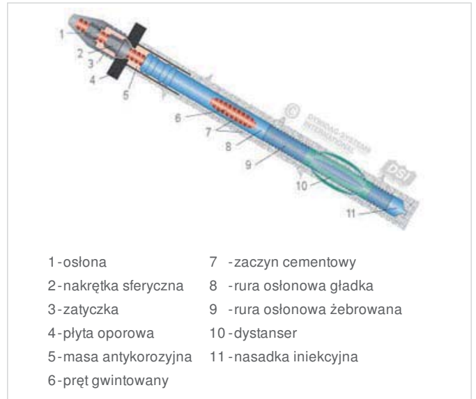
Ryc. 5. Schemat stałej kotwy prętowej
