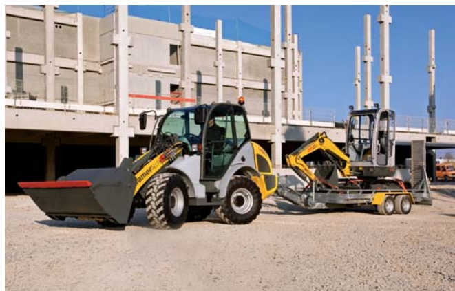
Ładowarka Kramer 480 (0,85–1,3m 3 ; 45 kw/61 KM) holująca minikoparkę Wacker Neuson 28z 3 (2,8 t, kabina zero tail)
