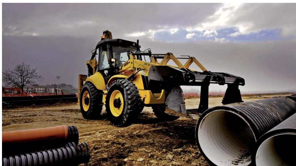
Koparko-ładowarka na 4 równych kołach skrętnych: New Holland B115B (1,2m 3 , 112 KM, pompa wielotłoczkowa)
