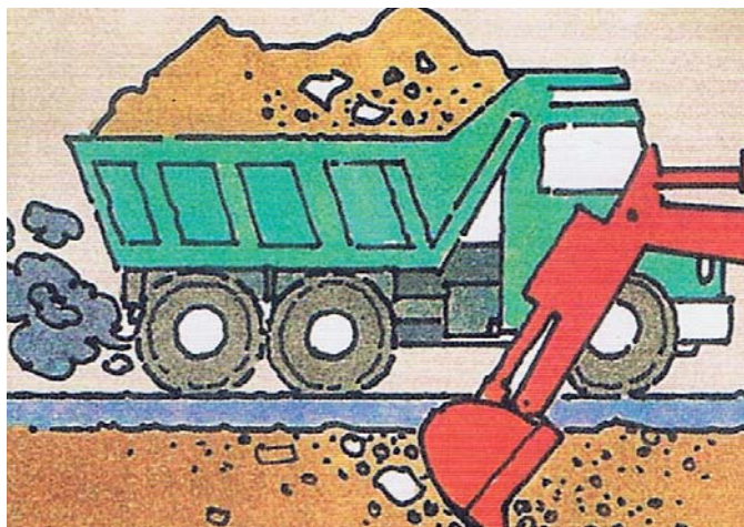
Ryc. 1. Wywożenie i ponowne przywożenie gruntu, kolejno w trakcie rozpoczynania robót ziemnych i po zakończeniu wbudowania rurociągu, przy budowie nowych przewodów tradycyjną metodą wykopową [2, 4]
