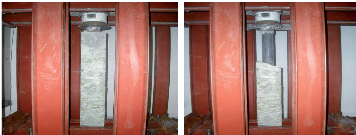
Ryc. 3. Próbkę w maszynie wytrzymałościowej przed i po zniszczeniu
