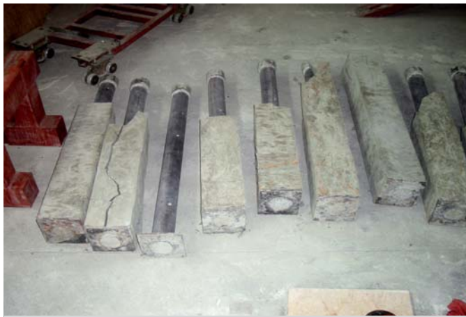
Ryc. 4. Różne formy zniszczenia otuliny z zaczynu cementowego podczas badania
