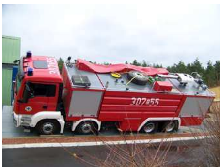
Fot. 1. Samochód pożarniczy z widocznym deflektorem
