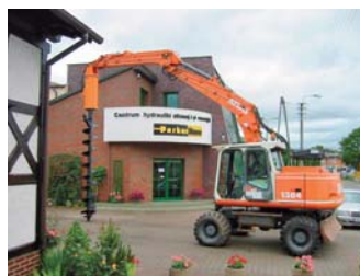
Głowica OWK-800 ze świdrem CFA obrotowym z boczny przyłączem betonu
