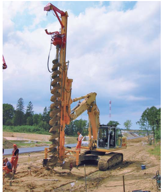
Osprzęt koparkowy masztowy typu OKM-800 z wciągarką do podnoszenia zbrojenia
