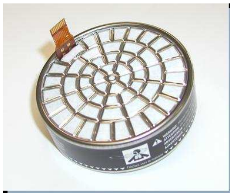
Fot. 7. Prototypowy filtropochłaniacz z detektorem żywotności
