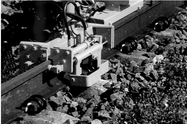
Rys. 30. Zapinarka spalinowa typu AP11 firmy Geismar: a) widok ogólny, b) szczegół mechanizmu zapinającego łapki
