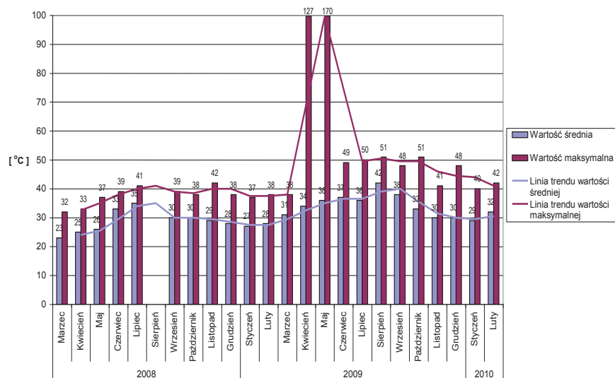
Rys. 9. Średnia i maksymalna miesięczna temperatura pracy łożyska rejestrowana z czujnika CTŁ5
