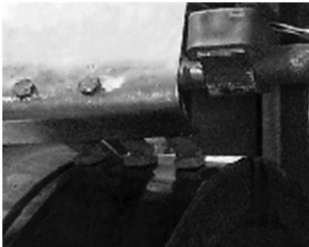
Rys. 3. Pomiar temperatury koła za pomocą termopar zamontowanych w ślizgaczach
