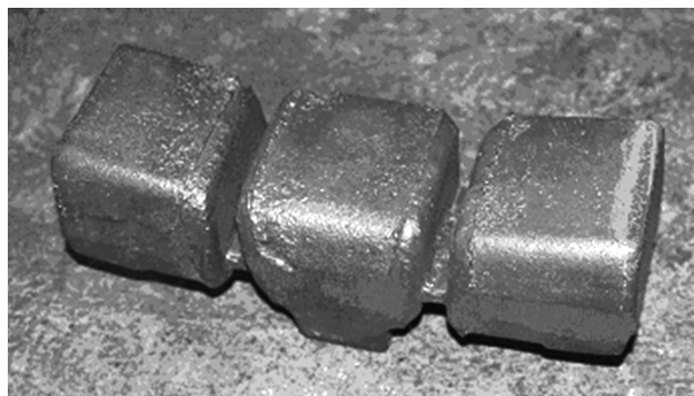
Rys. 1. Żeliwna segmentowa wstawka hamulcowa; szczegółowy opis konstrukcji wstawki segmentowej znajduje się w [1–3].
