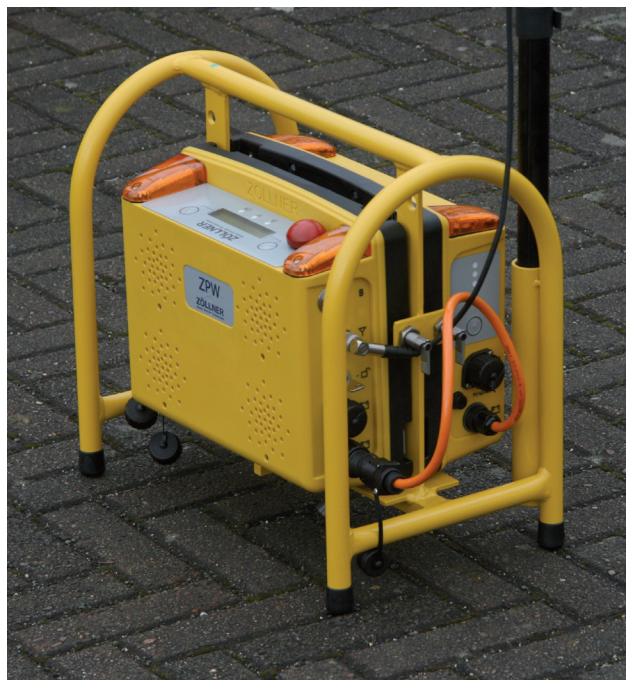
Rys. 5. Sygnalizatory radiowe ZPW Mobilnego Systemu Ostrzegania
