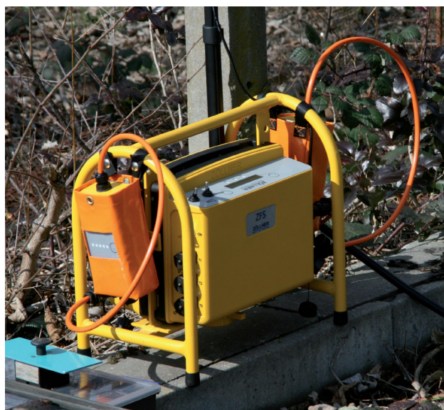
Rys. 6. Nadajnik radiowy ZFS Mobilnego Systemu Ostrzegania
