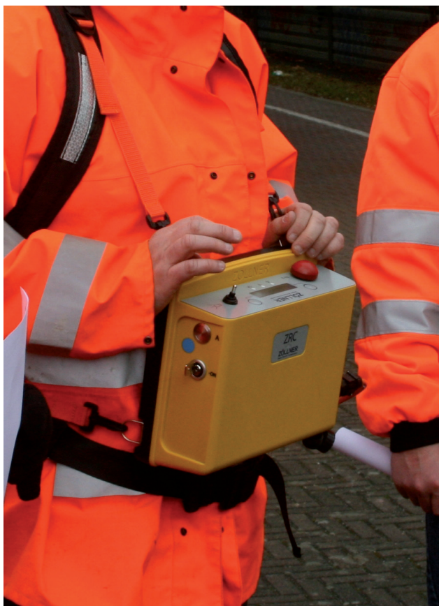
Rys. 4. Centrala ZRC Mobilnego Systemu Ostrzegania
