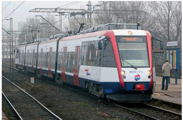
Pierwszy zespół trakcyjny polskiej produkcji (PESA) budowy niskopodłogowej, z silnikami asynchronicznym eksploatowany na linii WKD (600 V DC) Fot. P. Terczyński
