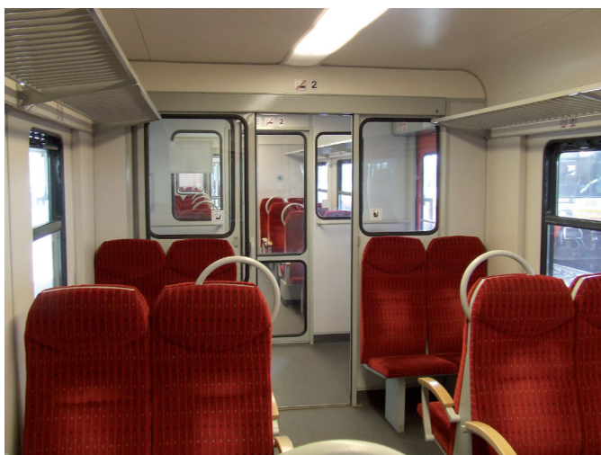
Przebudowane wnętrze przedziału pasażerskiego zespołu serii EN57 z przeszklonymi ściankami działowymi Fot. P. Terczyński
