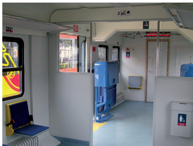
Kompleksowa modernizacja wnętrza EN57 dla trójmiejskiej SKM; w miejscu dawnego przedziału bagażowego zainstalowana winda dla wózków inwalidzkich Fot. P. Terczyński
