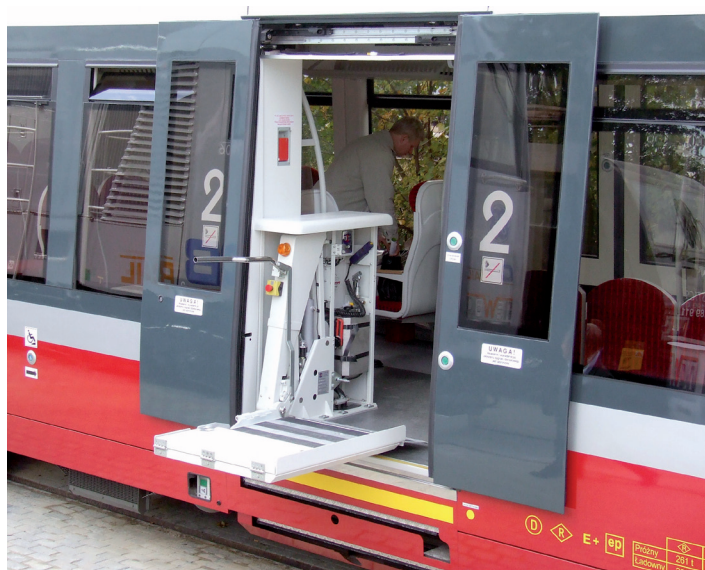
Drzwi wejściowe do przedziału z windą dla wózków w zespole serii ED74 Fot. P. Terczyński
