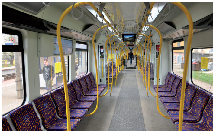
Jednoprzestrzenne wnętrze zespołu typu 19WE (warszawska SKM) dostosowane do warunków ruchu wewnątrzaglomeracyjnego Fot. M. Graff
