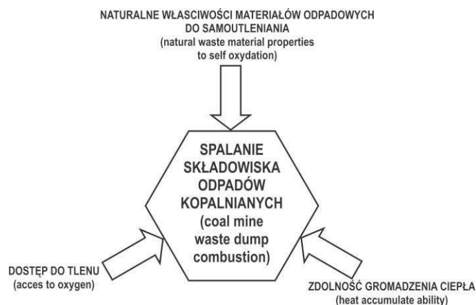
Rys. 2. Warunki konieczne do samozapalenia składowiska odpadów Fig. 2. Necessary conditions for waste dump self combustion
