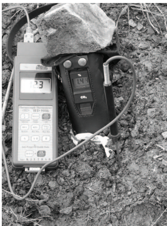
Rys. 5. Pomiar temperatury i CO 2 za pomocą sond wbijanych na składowisku odpadów powęglowych „Waleska” (Łaziska Górne, Górny Śląsk)
