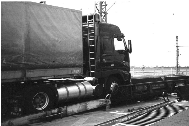
Rys. 2. Wjazd samochodu ciężarowego na wagon niskopodwoziowy „ruchomej drogi”: Źródło: A. Etmanowicz
