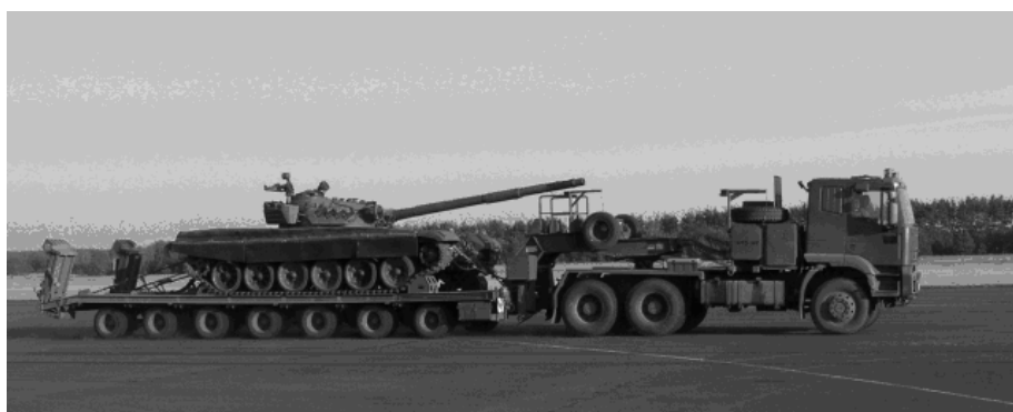
Rys. 3. Ciągnik siodłowy IVECO TRAKKER z naczepą niskopodwoziową NS700W. Fig. 3. Vehicle IVECO TRAKKER with semi-trailer NS700W.
