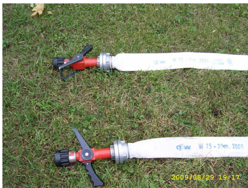
Fot.3. Końce węży zaślepione prądownicami
