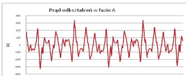
Rys. 4a. Przebieg prądu odkształceń widziany w jednej fazie
