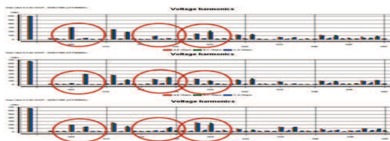
Rys. 2. Zmienność widma wyższych harmonicznych napięcia zależnie od kąta wysterowania 6-ciopulsowego przekształtnika tyrystorowego, oraz fazy pracy napędu maszyny wyciągowej
