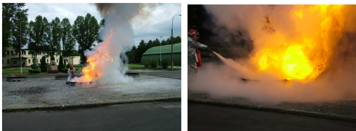
Ryc. 6. Gaszenie pożaru testowego grupy B.
