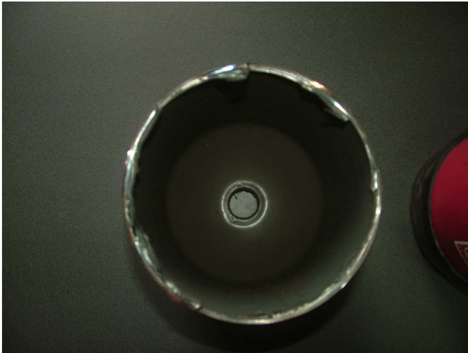
Ryc. 7. Zbiornik gaśnicy pianowej bez pęknięć lub pęcherzyków na powierzchniach antykorozyjnego zabezpieczenia.
