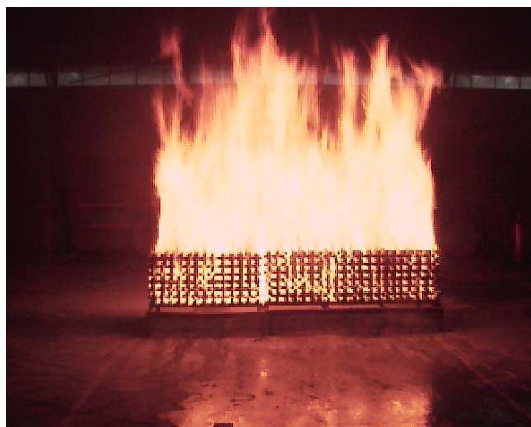
Ryc. 5 Pożary testowe grupy A w trakcie spalania i po spalaniu
