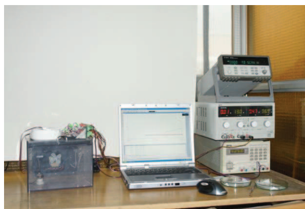
Rys. 3. Stanowisko laboratoryjne do badania zagrzewania próbek taśm przenośnikowych
