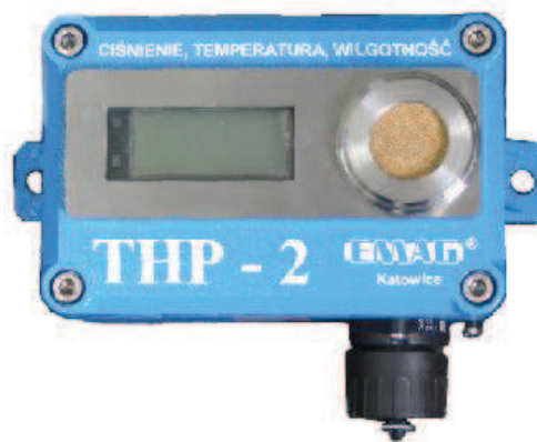
Fot. 4. Przyrząd THP-2 do pomiaru parametrów i wyznaczania potencjału aerodynamicznego
