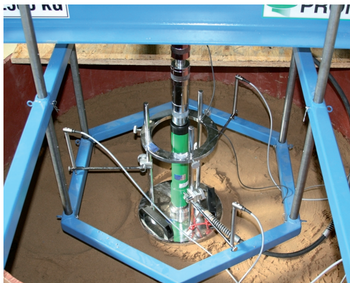
Rys. 4. Płyta VSS; dźwignik hydrauliczny; przeciwwaga; czujniki pomiarowe; statyw do czujników
