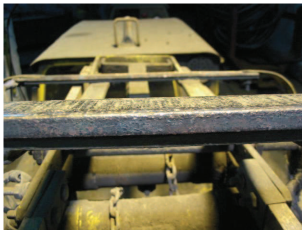
Rys. 7. Wygląd powierzchni styku ślizgowego z kompozytu Cu-Mo po około półrocznym okresie eksploatacji w trakcji kolejowej kopalni miedzi
