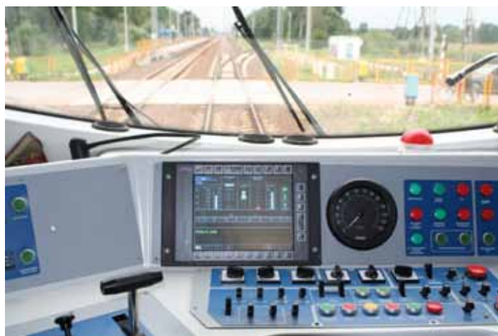
Rys. 2. Pulpit zespołu EN57SKM po modernizacji
