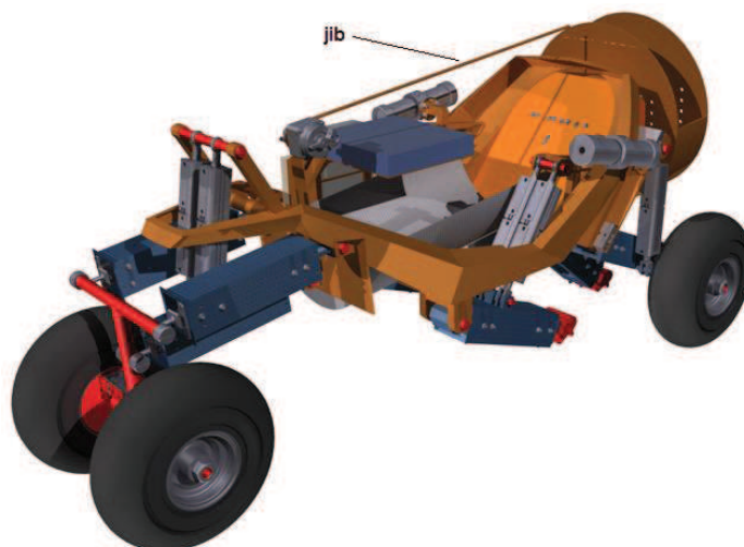
Rys. 2. Model podwozia robota z położonym wysięgnikiem Fig. 2. Model of the robot chassis with furlled jib
