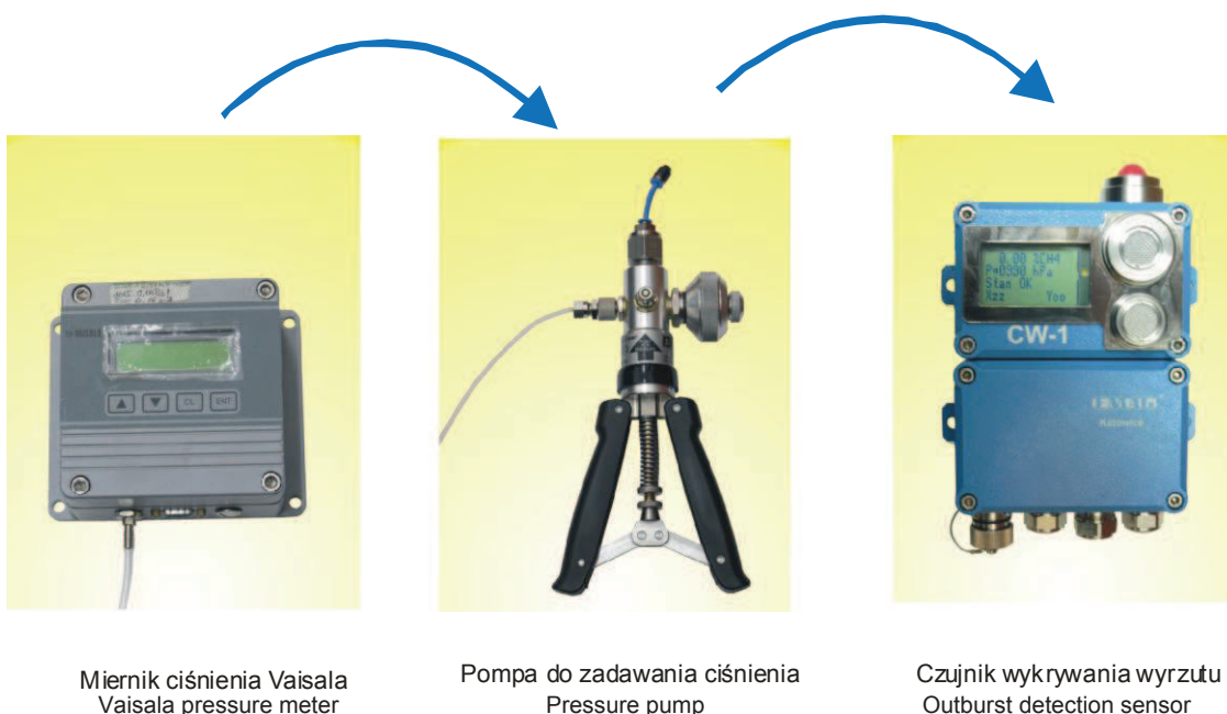
Rys. 8. Schemat kalibracji i zdejmowania charakterystyki statycznej czujnika ciśnienia Fig. 8. Diagram of calibration and determination of static characteristics of the pressure sensor
