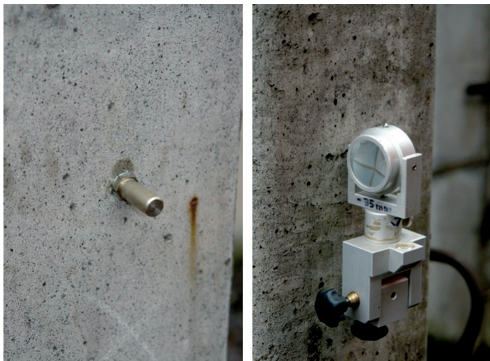
Rys. 2. Znak (wskaznik) regulacji toru umieszczony na słupie trakcyjnym oraz reflektor przyrządczy z uchwytem mocującym, założony na jednym ze wskaźników
