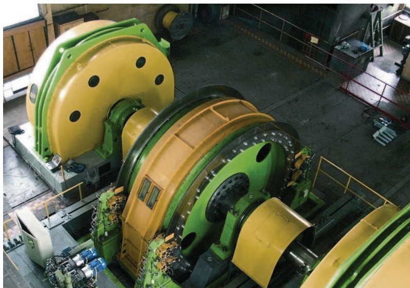
Rys. 1. Dwusilnikowa maszyna wyciągowa wyciągu skipowego z hamulcem tarczowym odwodzonym hydraulicznie
