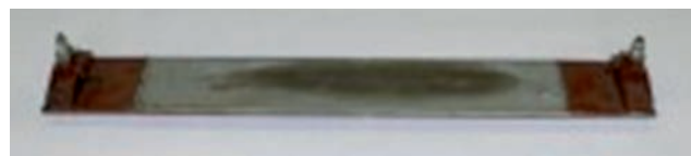
Rys. 4. Grzałka stosowana w krajowych wagonach samowyładawczych do przewozu węgla brunatnego
