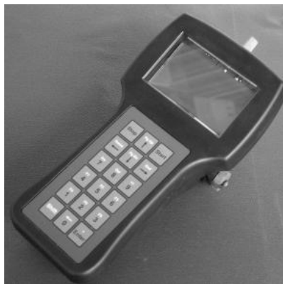
Fotografia 1. Ręczny przyrząd do pomiaru parametrów fizycznych powietrza THP-2/R
