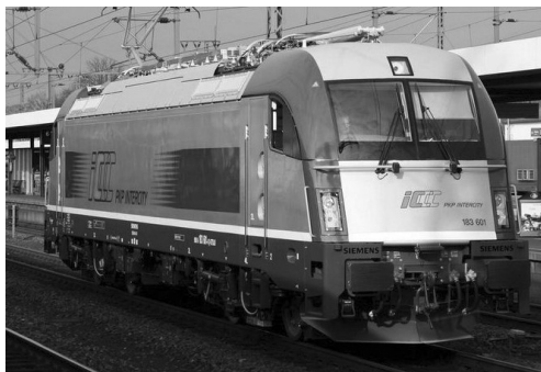
Rys. 31. Lokomotywa elektryczna ES64U4 w barwach PKP Intercity S.A. [21]
