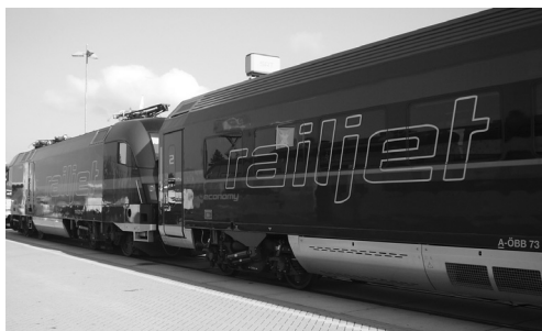
Rys. 32. Pociąg kolei austriackich Railjet utworzony z lokomotywy serii 1216 i indywidualnych wagonów [fot. J. Kukulski]
