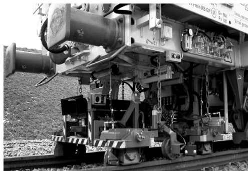
Rys. 5. Sposób zmontowania sensorów systemu PALAS [6]
