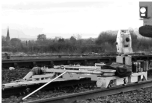
Rys. 4. Wózek pomiarowy systemu TQM [8]
