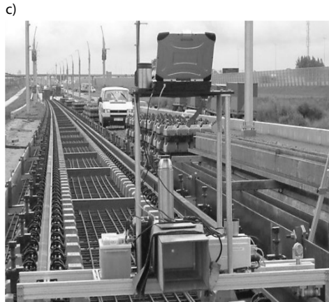
Rys. 3. Wózki pomiarowe: a) Katedry Geodezji Inżynierskiej i Budownictwa AGH [fot. M. Strach], b) systemu Geo++® GNBAHN [6], c) systemu Intermetric [7]
