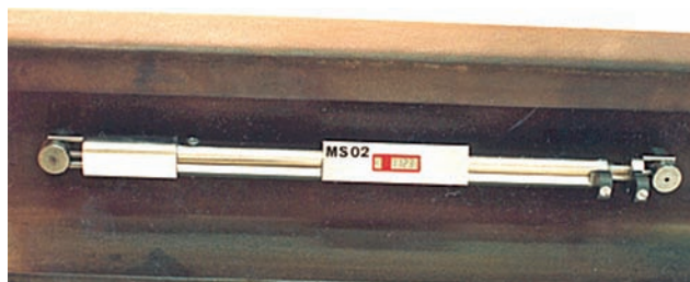
Rys. 5. Przyrząd MS-02 do pomiaru sił podłużnych w szynach toru bezстыkowego
