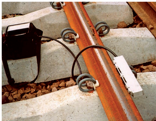
Rys. 6. Ultradźwiękowy miernik naprężeń przypowierzchniowych (system DEBRO)
