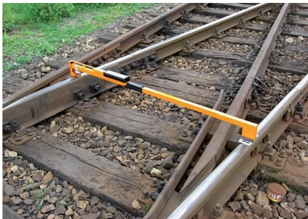
Rys. 2 – Przyrząd elektroniczny do toru i rozjazdów DTG-1435
