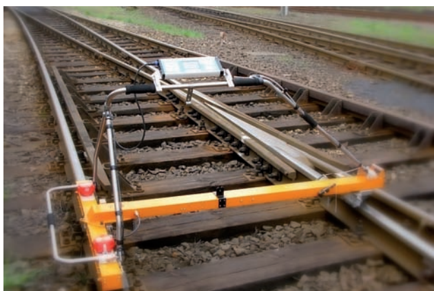
Rys. 3 – Toromierz do pomiaru rozjazdów i toru TEE-1435
