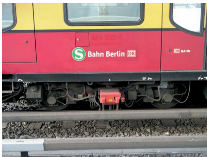
Płozka (ślizgacz) służąca do odbioru prądu z trzeciej szyny w zespole serii 481/482 (13.06.2009 r.)
