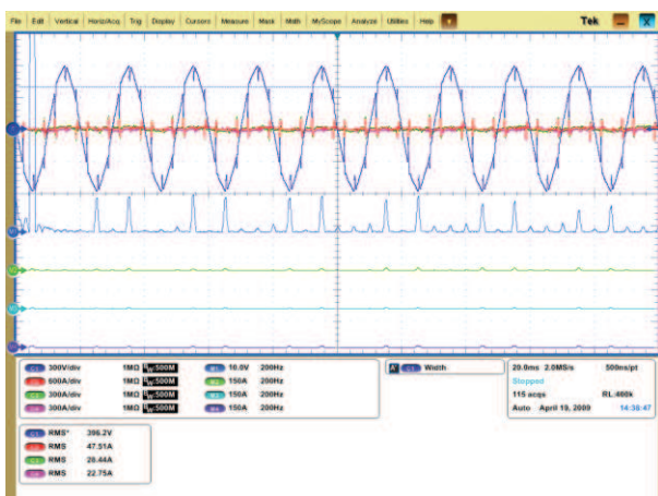
Rys. 17. Przebieg napięcia w sieci zasilającej maszynę wyciągową oraz widmo jego harmonicznych przed kompensacją
