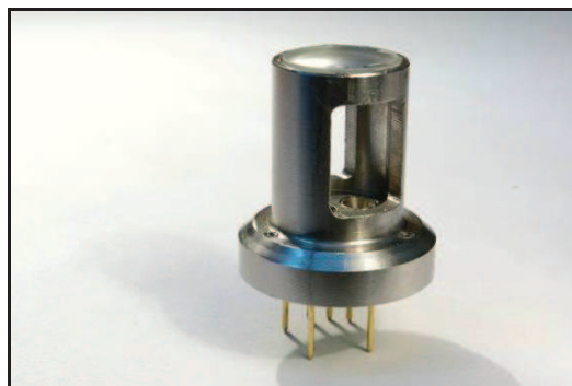
Rys. 3. Komora do pomiaru metanu
