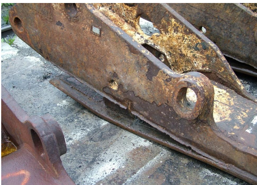
Rys. 1. Przykład uszkodzenia spoiny eliminującego element z dalszego użytkowania Fig. 1. An example of weld damage which excludes the element from further operation
