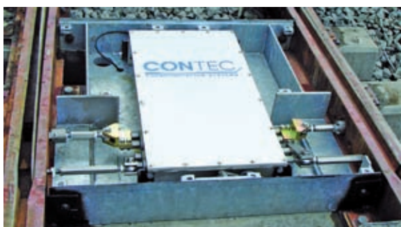
Rys. 3. Napęd zwrotnicowy CSV 24 firmy CONTEC
