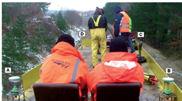
Rys. 1. Rozmieszczenie anten odbiorników GNSS systemu Leica 1200 (A, B, C, D) na platformie wózka motorowego WM 15
