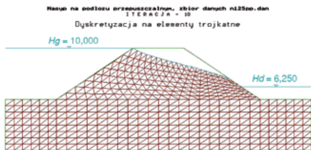
Rys. 7. Dyskretyzacja obszaru filtracji przy maksymalnym poziomie piętrzenia ( H ) i podtopieniu skarpy do poziomu 0,25 H
