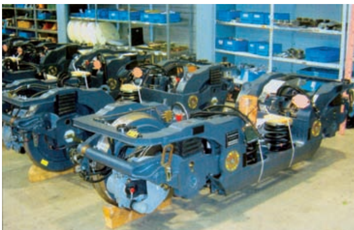
Rys. 36. Kolejka vario dla Bochum, zespół jezdny toczy z hamulcami szynowymi; uwagę zwraca usprężynowanie śrubowe drugiego stopnia
