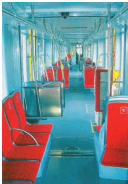
Rys. 21. Bombardier Outlook, Innsbruck; 27,6×2,4 m, korytarz 640 mm – o tej samej szerokości dla toru 1-metrowego i normalnego
