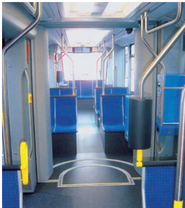
Rys. 32. Monachium, WT5; podniesiona platforma ponad zespołem jezdnyim z małą rampą, siedzenia pozostały prawie na tej samej wysokości
