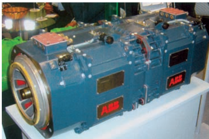
Rys. 23. Sprzężone silniki produkcji ABB dla tramwajów niskopodłogowych firmy CAF, na zdjęciu dla pojazdu Victoria, wystawione na wystawie InnoTrans
