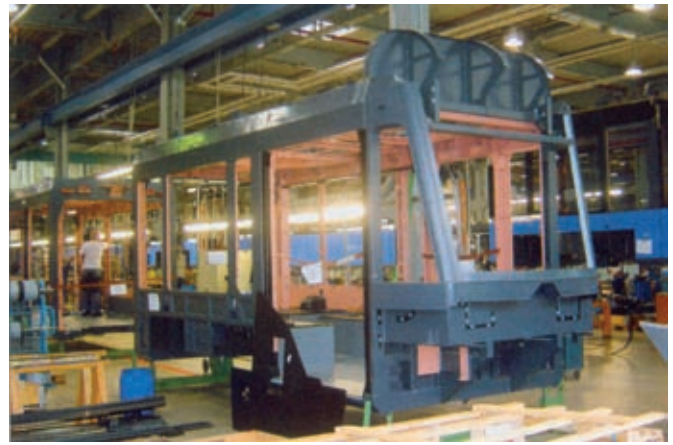
Rys. 29. Kolejka vario ze stali nierdzewnej dla Monachium w budowie w zakładach w Pankow
