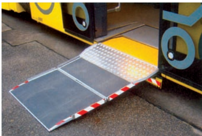
Rys. 16. Berlin, ręcznie obsługiwany podjazd całkowicie wysunięty
