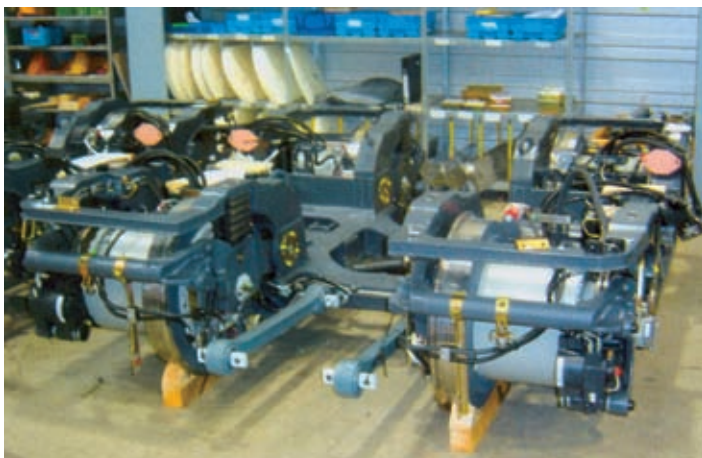
Rys. 35. Kolejka vario dla Bochum, zespół jezdny napędny z silnikami, wahacze z gumowo-metalowymi tłumikami i połączenie przegubowe
