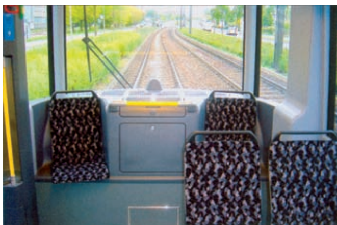
Rys. 17. Berlin, tył pojazdu z pomocniczym pulpitem motorniczego
