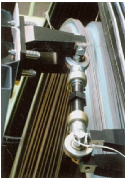
Rys. 18. Przegub poprzeczny, z jednej strony jeszcze nie zamontowany. Źr. Bombardier
