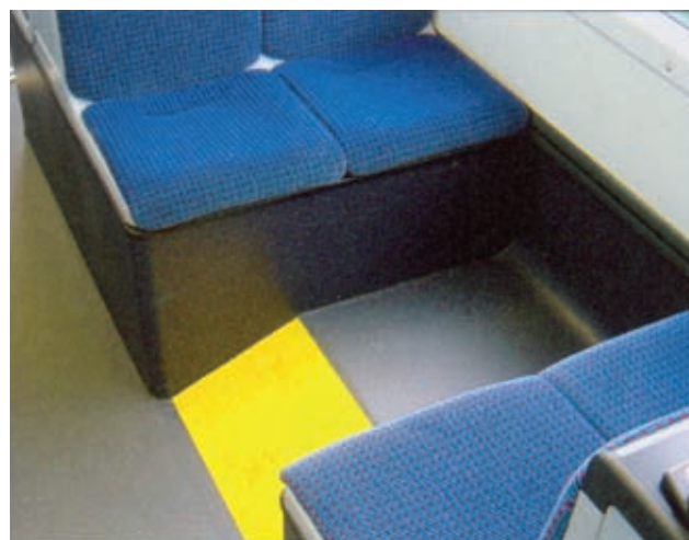
Rys. 27. Kolejka vario, siedzenia ponad zespołem jezdny, zbyt strome podesty
