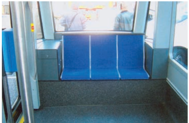
Rys. 31. Kolejka vario dla Monachium, wejście tylne oraz pomocniczy pulpit motorniczego
