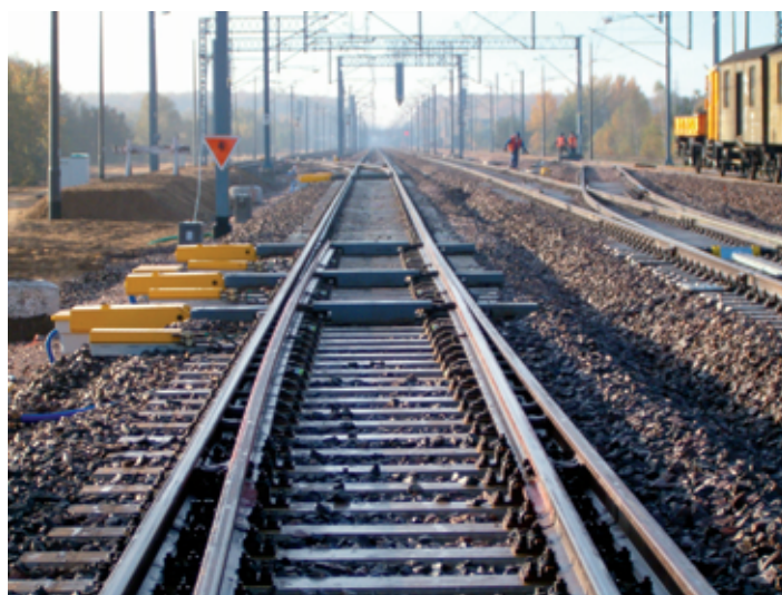
Rys. 3. Zwrotnica rozjazdu Rz 60E1-1200-1:18,5 firmy „KolTram” Fot. D.Korab
