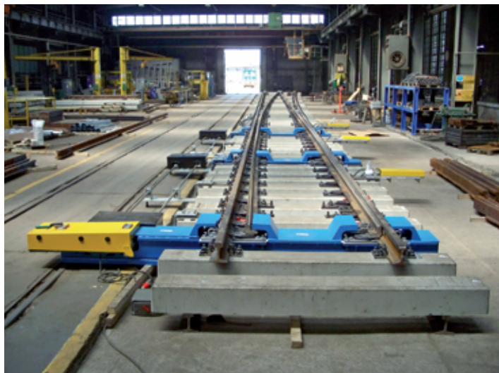
Rys. 8. Prototypowy rozjazd Rz 60E1-760-1:14 KZN „Biezanów”
