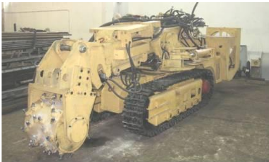
Rys. 7. Widok prototypowej ładowarki z zamontowanym organem urabiającym
