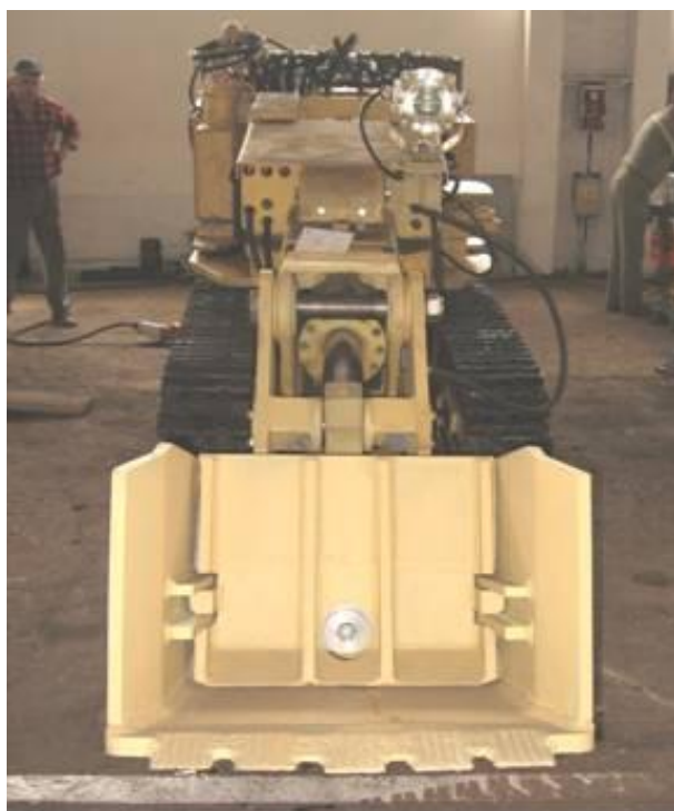
Rys. 8. Widok prototypowej ładowarki z zamontowanym zespołem ładującym wykonanym jako czerpak z wysuwną tylną ścianką
