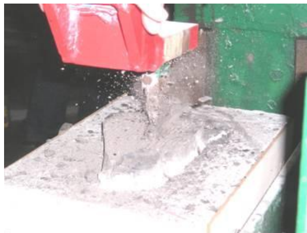
Rys. 2. Widok próbki skalnej podczas wykonywania skrawu pomiarowego
