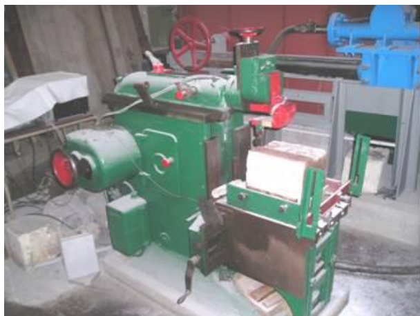
Rys. 1. Widok specjalnego laboratoryjnego stanowiska do badania oporów skrawania
