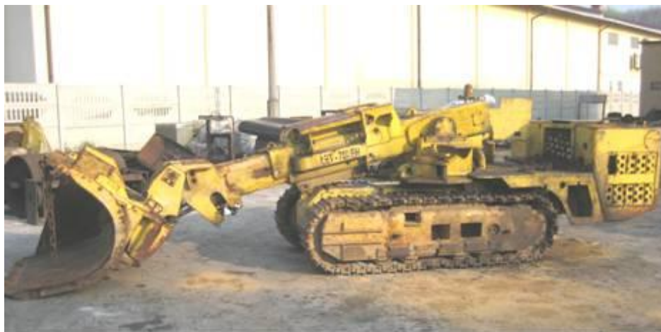
Rys. 6. Widok ładowarki dołowej bocznie sypiącej typ LBT 700-EH, produkowanej przez Hutę Bumar Łabędy w Gliwicach
