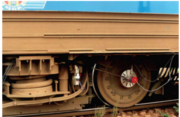
Rys. 2. Przyrządy rejestrujące zamocowane na wózku wagonu NGT6
