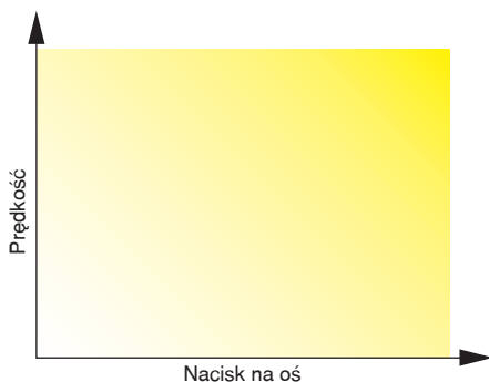
Rys. 5. Zestawienie zwiększenia wielkości współczynnika zużycia infrastruktury w zależności od średniego nacisku na oś oraz prędkości maksymalnej
