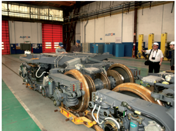
Rys. 17. Wózki z mechanizmem przechyłu nadwozia przed montażem pod wagonami Fot. S. Puławska
